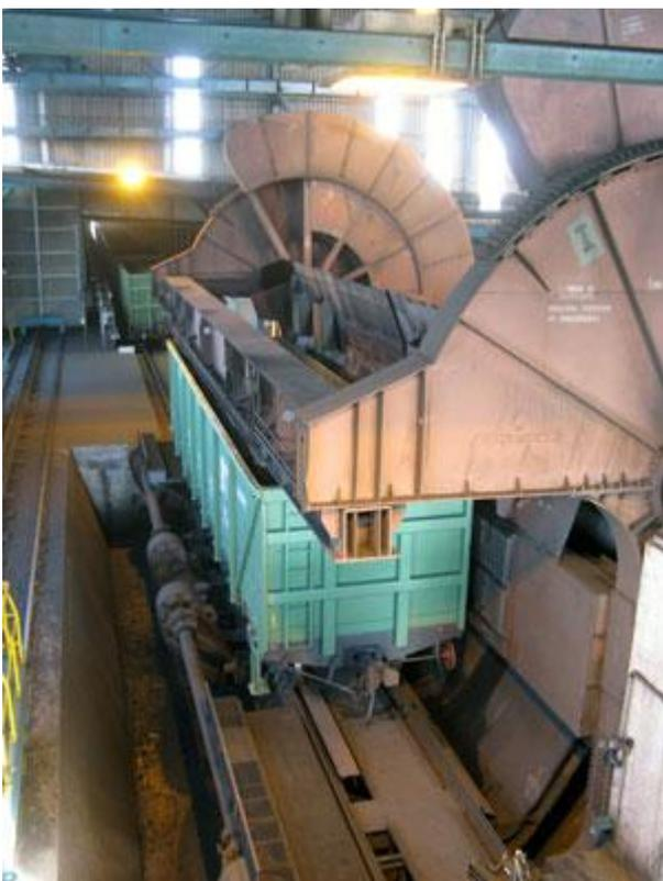
Использование в порту современных вагоноопрокидывателей также позволяет минимизировать вредное воздействие угольной пыли на окружающую среду.
